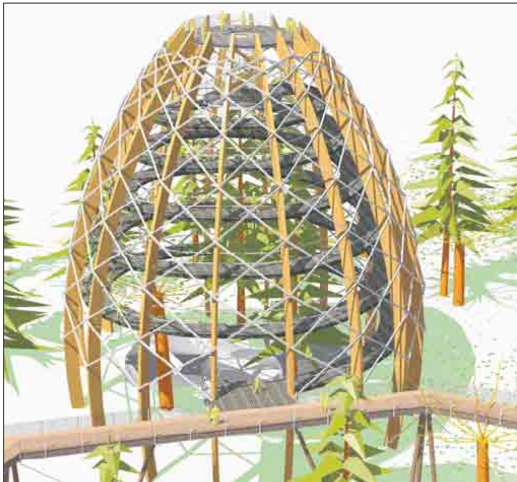
Der Aussichtsturm erinnert an ein gotisches Kreuzrippgewölbe. 500 Meter lang ist die Rampe, auf der die Besucher die Aussichtsplattform erreichen und in 44 Meter Höhe die Aussicht genießen können.
